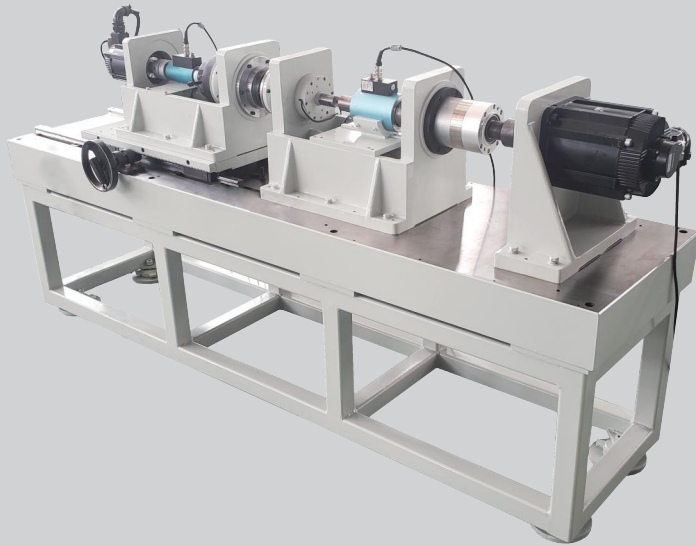
5~20000N.m RV、ハーモニック減速機テストベンチ RV, harmonic reducer comprehensive test bench
